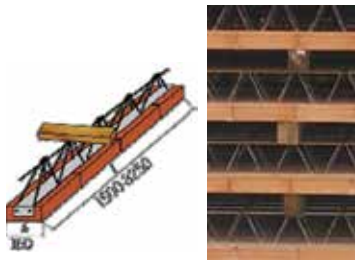
Ábra: Az alátétek megfelelő elhelyezése 7. kép: Példa födémgerendák lerakatára
